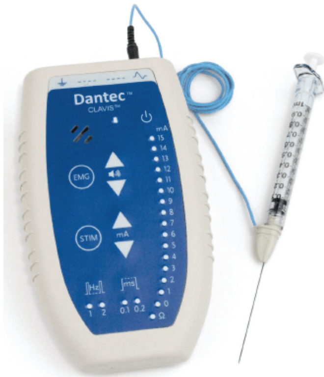
Figure 1: Boîtier de stimulation / détection EMG, aiguille intra-musculaire reliée au boîtier et seringue de 1 mL
